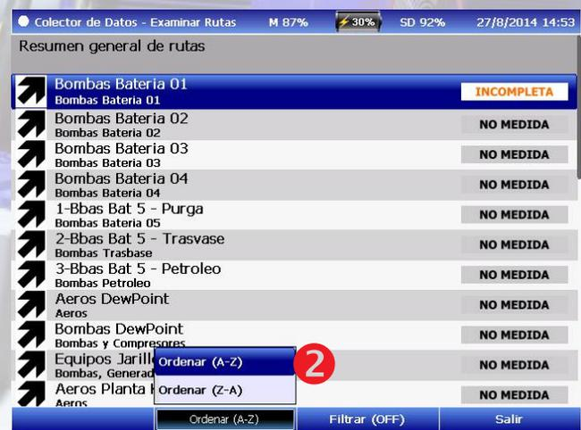
El equipo DSP Logger Expert, posee un alto rendimiento en velocidad de medición en el modo rápido. Ejemplo de configuración: Planta de 5 equipos con 10 puntos, c/u espectro de velocidad 500 Hz-800 líneas y espectro aceleración 10 KHz-800 líneas.
