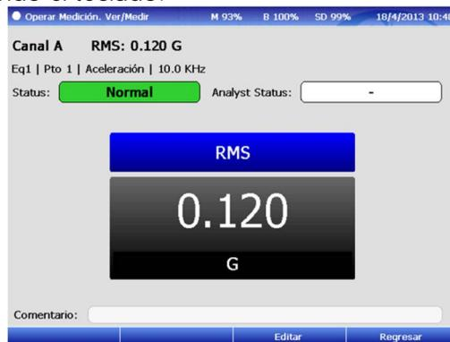
Una vez completada una ruta se puede consultar el estado de cada equipo perteneciente a esa ruta, por ejemplo, selecciono un equipo cualquiera (con las teclas Arriba, Abajo) y con F3 puedo visualizar el estado de puntos de ese equipo o ver un detalle del mismo.
